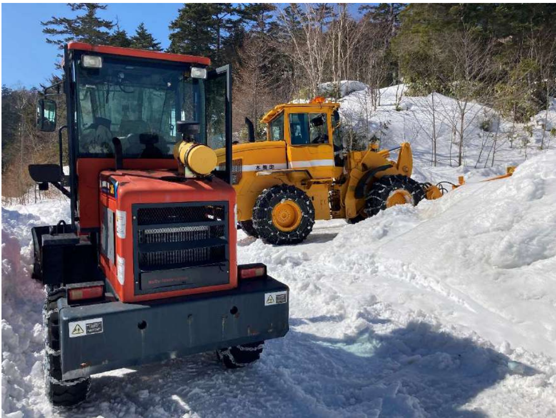
地元支所の 13 トンローダーが開通・拡幅し、2 トンでコース整備をするという今の体制
